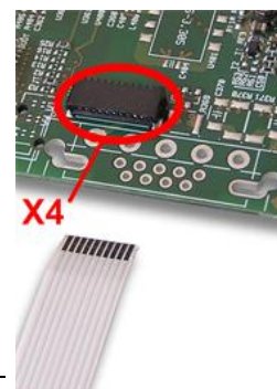
Abbildung 29: CANopen-Aufsteckschnittstelle (AIFX-CO) an die Grundkarte CIFX 104-FB-R\F anschließen (Beispiel)
