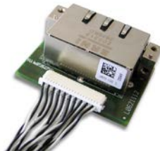
Abbildung 28: Ethernet-Aufsteckschnittstelle (AIFX-RE) an die Grundkarte CIFX 104-RE\F anschließen (Beispiel)
