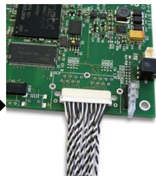
Abbildung 28: Ethernet-Aufsteckschnittstelle (AIFX-RE) an die Grundkarte CIFX 104-RE\F anschließen (Beispiel)
